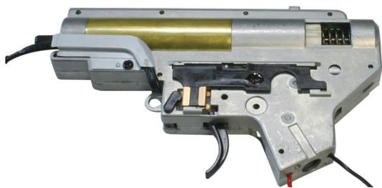
M4 タイプ ( バッテリー配線が後方にあるタイプ ) への組み込みでは配線を後方にする作業を伴います。
