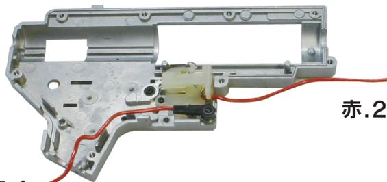
4. 黒い線を外した状態。続いて赤い線も後方にまわします。図の「赤.2」を後方へまわします。
