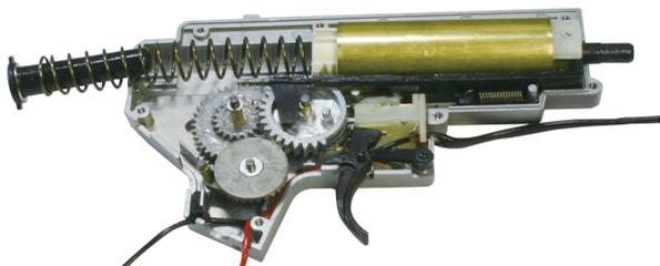
2. メカBOXを分解しますが図のようにSPRINGガイドが飛び出しますので慎重に開けてください。
